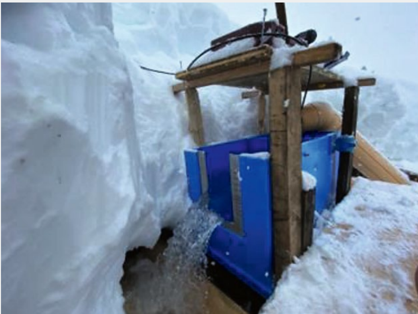
Fig. 6 Mobile Messung der Schüttung einer Quelle der Wasserversorgung St. Antönien.
