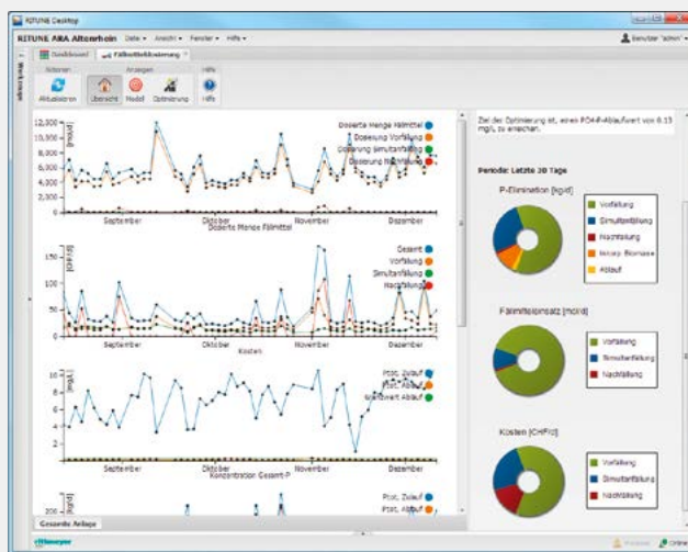
Fig. 6 Optimierung der Fällmitteldosierung auf der Kläranlage Altenrhein (Einsatz seit 1. Juli 2014). Die Gesamtkosten für Fällmittel konnten ohne negative Auswirkungen auf die Ablaufqualität um 30% gesenkt werden Optimisation du dosage de précipité à la station d'épuration d'Altenrhein (utilisation depuis le 1 er juillet 2014). Les coûts totaux pour le précipité ont pu être réduits de 30%, sans répercussions négatives sur la qualité de l'effluent
